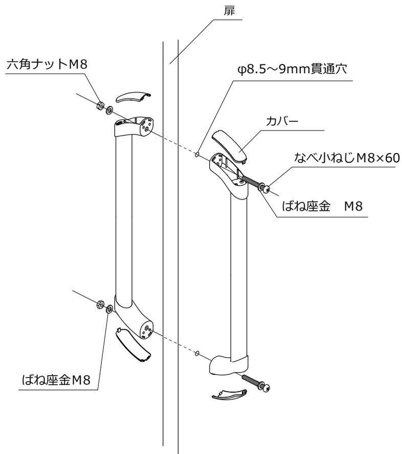
扉に8.5~9mmの貫通穴を425mmの間隔に空け、同梱されている小ねじ、座金、ナットを使用し上図の様に取付けて下さい。
