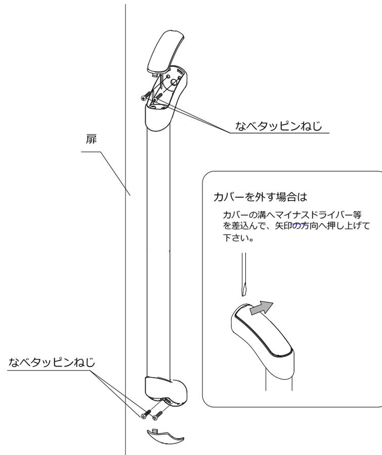
同梱されているなべタッピンねじを使用し上図の様に取付けて下さい。
